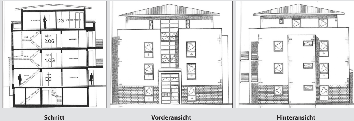
Abb. 14: Schnitt und Ansichten (Bestandteil Teilungserklärung)
